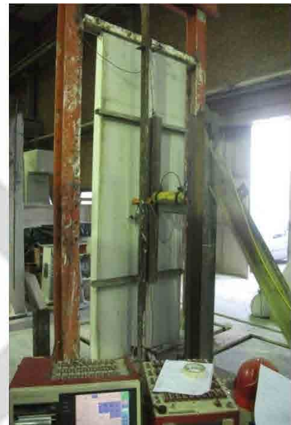
شکل ۴-۱۰ محل استقرار تغییر مکان سنج‌های الکترونیکی شکل ۴-۱۱ ست آب بارگذاری خمشی
