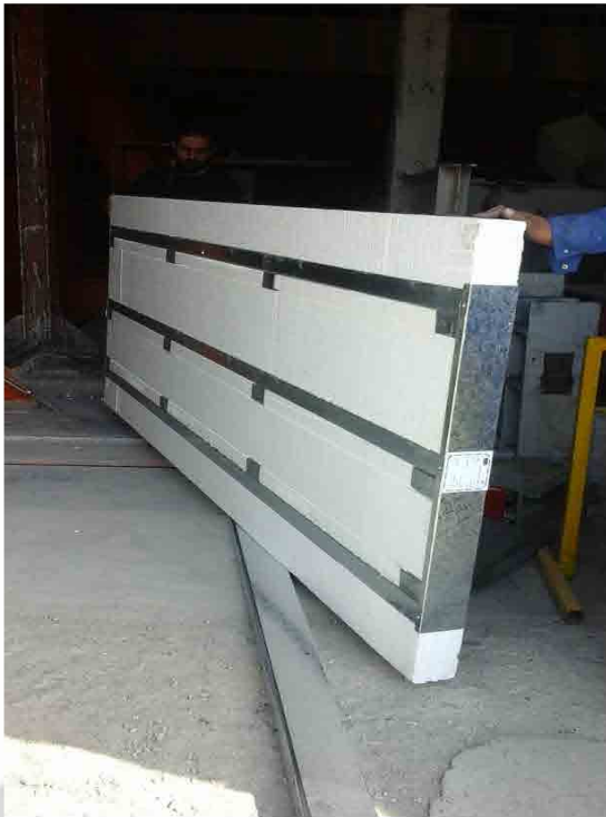
شکل ۲-۳ نمونه دیوار متشکل از پلی استایلین و استاد
