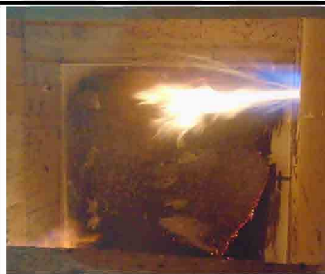
شکل ۵-۷: سوختن کاغذ تخته گچی سطح در معرض آزمون (دقیقه ۲)
