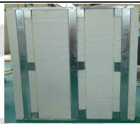
شکل ۵-۵: آزمون قبل از نصب تخته گچی
