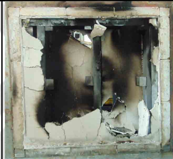
شکل ۵-۱۲: جدا شدن تخته گچی در سطح غیر معرض از پروفیل وسط و شکست یکپارچگی (دقیقه ۴۵)
