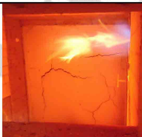
شکل ۵-۹: عمیق تر شدن ترک خوردگی تخته گچی در سطح در معرض (دقیقه ۴۴)
